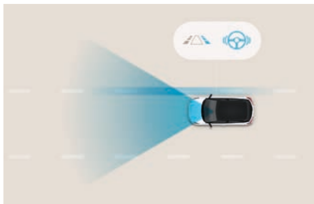
Sistema activo de cambio involuntario de carril (LKA). Este sistema utiliza la cámara frontal para monitorizar las líneas de la calzada. En caso de cambio involuntario de carril, el sistema te avisa e interviene sobre la dirección para devolver el coche a su carril.
