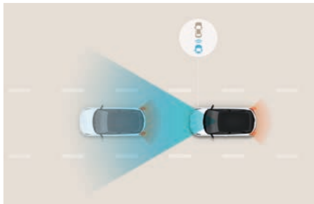
Sistema de asistencia a la frenada de emergencia (FCA). La carretera se monitoriza en todo momento gracias a un radar y una cámara en la parte frontal del vehículo; el sistema FCA te avisa y activa automáticamente el freno si detecta un frenazo repentino en el coche que circula delante o peatones o ciclistas cruzando la vía.
