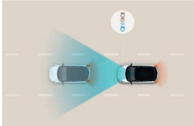
Sistema de asistencia a la frenada de emergencia (FCA). La carretera se monitoriza en todo momento gracias a un radar y una cámara en la parte frontal del vehículo; el sistema FCA te avisa y activa automáticamente el freno si detecta un frenazo repentino en el coche que circula delante. Este sistema detecta también a peatones e incluso puede detectar también a ciclistas.
