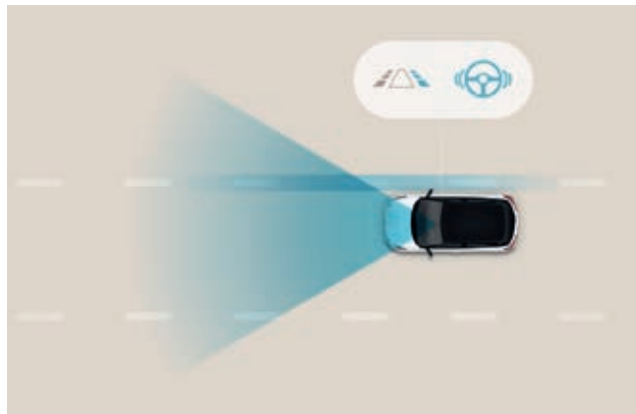
Sistema activo de cambio involuntario de carril (LKA). Este sistema utiliza la cámara frontal para monitorizar las líneas de la calzada. En caso de cambio involuntario de carril, el sistema avisa al conductor e interviene sobre la dirección para devolver el coche a su carril.
