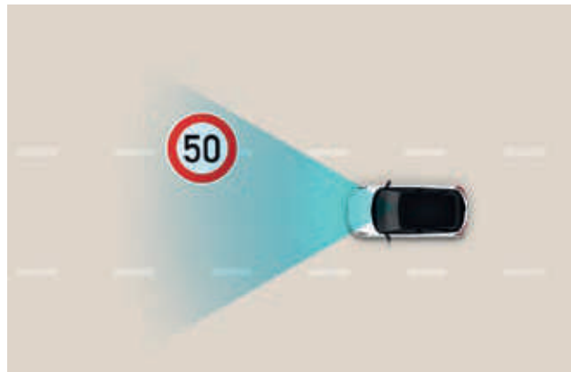
Asistente inteligente de límite de velocidad (ISLA) Este sistema emite alertas acústicas y visuales si circulas por encima de la velocidad permitida en la vía. Cuando se combina con el limitador manual de velocidad o el control de crucero inteligente, ISLA puede incluso ajustar la velocidad de forma autónoma.
