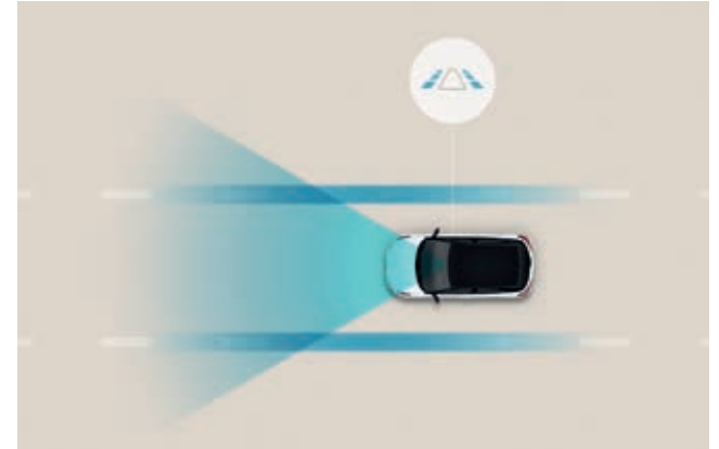
Asistente de seguimiento de carril (LFA). Cuando se activa, este sistema mantiene el vehículo centrado en su carril tanto en ciudad como en carretera.
