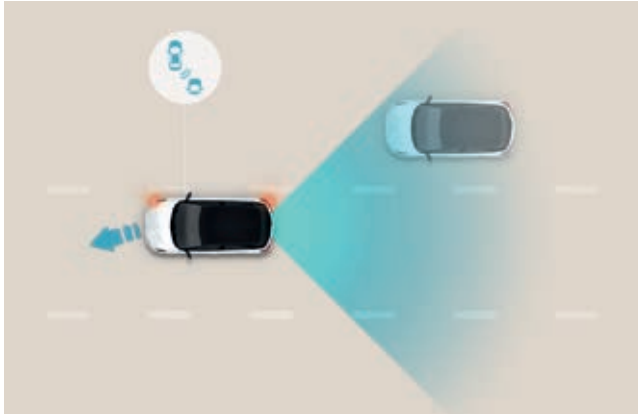
Sistema de detección de ángulo muerto (BCA). Mediante dos sensores situados en la parte inferior del paragolpes trasero, el sistema te avisa de los vehículos que se acercan por la zona del ángulo muerto. Si activas el intermitente en esa dirección, el sistema emite una señal acústica y activa el freno para evitar la colisión.
